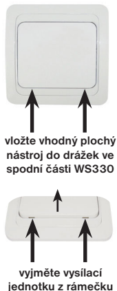
Obr.4 Demontáž vysílací jednotky
